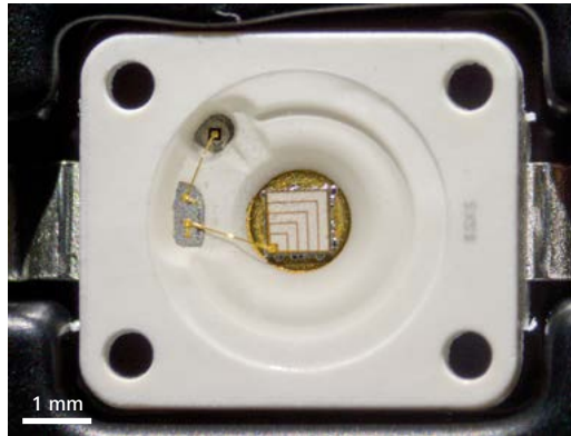
Besonders heller LED-Chip, Bonddrähte und Verpackung, LED-Spot K, schräges Auflicht, Zoom 1,25-fach
