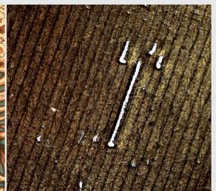
Laserkristallisiertes Silizium auf Glas,
