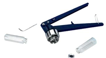
Verschleißzangen mit verstellbarem Bördeldruck und variabler Bördelhöhe. Jeder Verschleißzange liegt ein Inbusschlüssel bei, mit dem das Innere des Bördelkopfes herauf- bzw. heruntergefahren werden kann.
