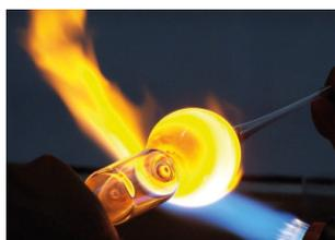
Glas besteht in erster Linie aus Siliziumdioxid, aber durch den Zusatz unterschiedlicher Oxide gewinnt das Material weitere positive Eigenschaften. Als Laborglas hat sich in diesem Bereich speziell Borosilikatglas durch seine idealen Eigenschaften hervorgehoben. In der Laborbranche sind Glasgeräte nicht wegzudenken, denn das Material bringt viele Vorteile mit sich, welche die Arbeit in einem Labor erst ermöglichen.
