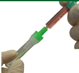
Das starke Nylonnetz ist in verschiedenen Porengrößen erhältlich und eignet sich daher ideal zur Trennung verschiedener Arten von Zell- und Kerngrößen. Das Gehäuse aus robustem Polypropylen passt genau sowohl auf 15-ml-Zentrifugenröhrchen als auch auf Standard-Probenröhrchen mit einem Innendurchmesser von 9,5 mm.
