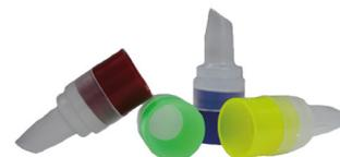
Das starke Nylonnetz ist in verschiedenen Porengrößen erhältlich und eignet sich daher ideal zur Trennung verschiedener Arten von Zell- und Kerngrößen. Das Gehäuse aus robustem Polypropylen passt genau sowohl auf 15-ml-Zentrifugenröhrchen als auch auf Standard-Probenröhrchen mit einem Innendurchmesser von 9,5 mm.
