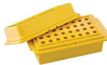
sind mit einem inerten, nicht-toxischen Gel gefüllt. 2 Temperaturbereiche erhältlich. CellCamper Kühlrack -20°C: nach 3 Stunden noch -10°C. CellCamper Kühlrack 0°C: Temperaturhaltezeit ca. 5 Stunden. Autoklavierbar.
