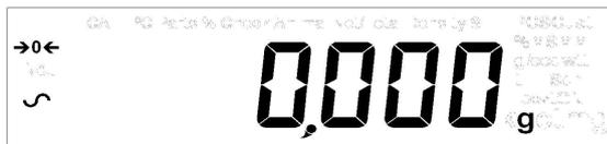
Das Display zeigt null als Wert, in der zuletzt verwendeten Wägeeinheit, außerdem das 'Null'-Symbol [→0/T←]. Wurde die Funktion 'automatische Justage' aktiviert, wird die Waage 15 Minuten nach Inbetriebnahme die Justage durchführen, und dann wieder entsprechend des eingestellten Zeitintervalls.
