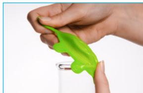
Positionieren Sie die Gefäßöffnungskante in den **Knick des Deckelinnenbereichs**.
