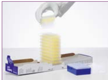
② Transferabdeckung anheben, Spitzen bleiben geschützt.
