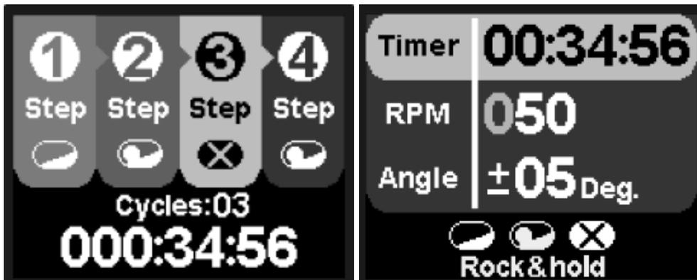
**Programmarten:** Das Gerät umfasst 3 Programmarten: *Rocking Mode* (einfach Kippbewegung), *Rock & hold* (Kippbewegung mit Haltefunktion) und *no operation* (Pausefunktion). Alle Programmarten sind individuell einstellbar in Zeit, Geschwindigkeit und ggf. Kippwinkel.
