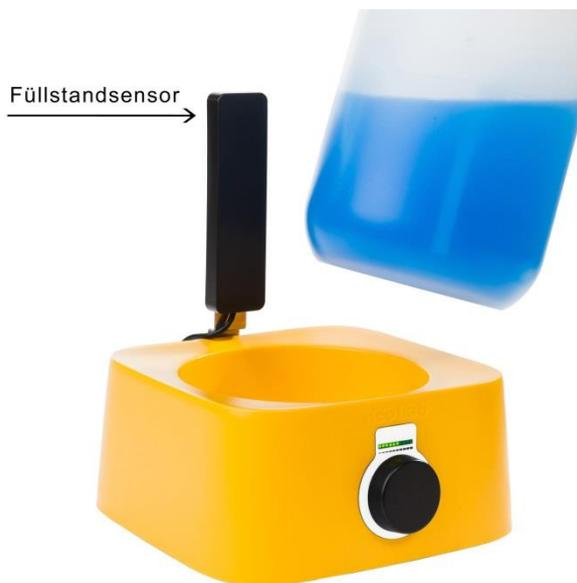
Der berührungslose Füllstandsensordarm verhindert ein Überfüllen der Sammelflasche und somit das Eindringen von Flüssigkeit in Filter und Gerät.
