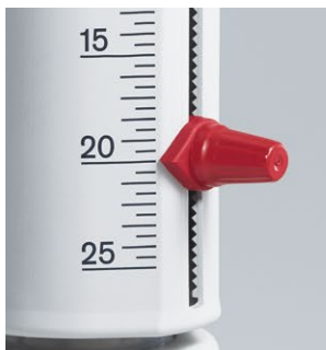
Sichere Fixierung des Volumens durch innenliegende Zahnleiste
