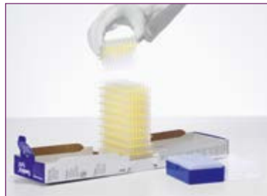
② Transferabdeckung anheben, Spitzen bleiben geschützt.
