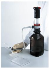
QuikSip<sup>™</sup>-Absaugegerät mit 8-Kanal-Pipettiereinheit zum Absaugen von Flüssigkeiten aus Mikrotiterplatten.
