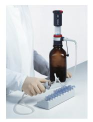
QuikSip<sup>™</sup>-Absaugegerät mit Einkanal-Pipettiereinheit zum Absaugen von Flüssigkeit aus Reaktionsgefäßen, Teströhrchen, usw.
