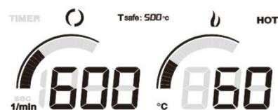
Die aktuelle Drehzahl und die aktuelle Temperatur.
