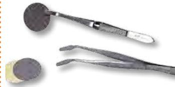
Pinzetten zur schonenden Handhabung von Membranfiltern, **vorne abgerundet und abgeflacht, aus Edelstahl.**
