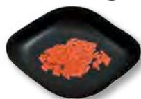
**Flexible, antistatische Polystyrol-Wägeschiffchen in Diamantform** erleichtern das Ausschütten. Die schwarze Farbe sorgt für **besseren Kontrast bei hellem Wägegut**. Das Material PS ist widerstandsfähig gegen schwache Säuren, wässrige Lösungen, Alkohol und Laugen. Temperaturbeständig bis 70°C.
