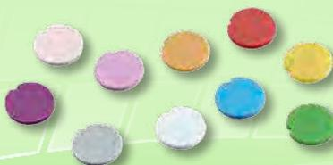
**Farbige Deckeleinsätze** für Reaktionsgefäß-Schraubverschlüsse, zur Codierung.
