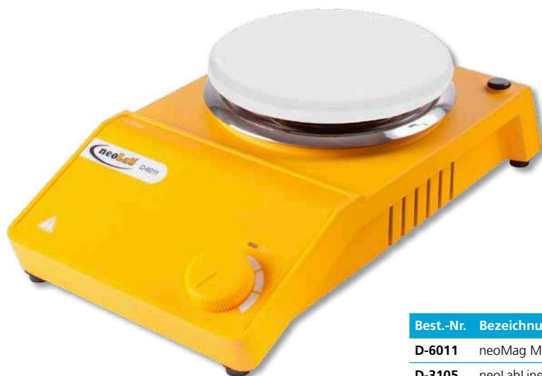
**Standard-Magnetrührer für bis zu 20 Liter** in flacher Bauweise mit variabler Geschwindigkeit von 0 bis 1500 UpM. Keramik-beschichtete Platte mit 135 mm Durchmesser. Wartungsfreier Motor mit elektronischer Geschwindigkeitsüberwachung und konstanter Geschwindigkeit auch bei Beladungsänderungen. Einstellung der Geschwindigkeit über Drehknopf. Für Magnetrührstäben bis 80 mm Länge geeignet.
