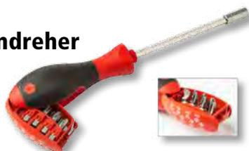
Mit Kraftgriff und 5 verschiedenen Schraubendreher-Bits, magnetisch. Hält Bits und Schrauben fest. Schaft aus Chrom-Vanadium-Stahl, kunststoffummantelt für sicheres Arbeiten, Bit-Magazin im Schaft mit durchsichtiger Wählscheibe: je 1 Bit für Schlitzschrauben 5,5 mm und 6,5 mm breit, je 1 Bit für Kreuzschrauben 1, 2 und 3 mm.
