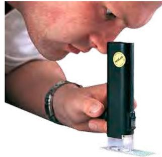
**Modell für die Oberflächenbetrachtung, mit Beleuchtung. 30-fache Vergrößerung**, mit Fokussier-einrichtung und Auflichtlinsen-Lampe.
